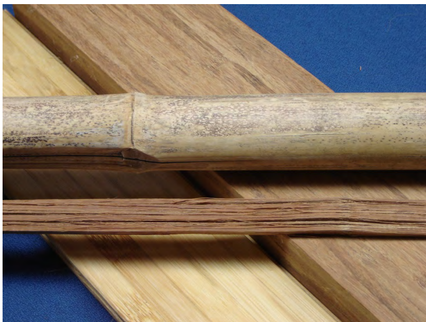
Figuur 4: Bamboe, verlijmd bamboeparket en -composiet
